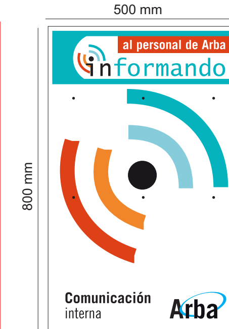
Respaldo de PVC de 5 mm de espesor con gráfica en vinilo impreso montado Impresión Ink-Jet, a 6 colores 1440 x 1440 dpi.
